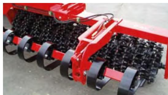
Barra niveladora accionada hidráulicamente delante de los anillos Crosskill.
