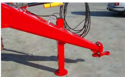
La pata de apoyo de manivela es estándar en los rodillos basculantes de 4,50 - 8,20 m. La pata de apoyo hidráulica es estándar en los Tip-Rollers de 9,50 y 10,20 m.
