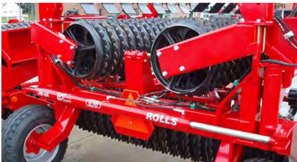
Todos los Tip-Rollers de 4,50 y 5,40 m y los modelos de 6,30 m con tamaños de aro hasta 600 mm están equipados con un sistema de transferencia de peso, consistente en un cilindro hidráulico para plegado y en el extremo opuesto, un muelle.
