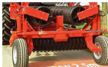
En la posición completamente plegada, el peso de las alas se distribuye entre el tractor y las ruedas de transporte, lo que mejora la estabilidad.
