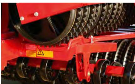
El diseño de los rodillos HE-VA de 3 secciones soporta la sección lateral horizontalmente en una cuna de bloqueo positivo que reduce el ruido durante el desplazamiento.
