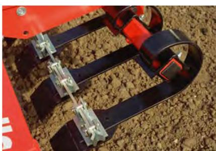
La barra niveladora, montada sobre muelles, aplasta los terrones y tiene un excelente efecto nivelador. El ángulo de las cuchillas puede ajustarse hidráulicamente desde el tractor para adaptarse a las condiciones del terreno en cada momento. Cada muelle mide 10 mm x 80mm y cubre una amplia superficie con puntas endurecidas de 150mm de anchura. La barra puede ser de púas en lugar de cuchillas de 16mm.
