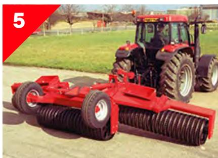
Incline los rodillos hacia delante hasta que el cilindro toque fondo
