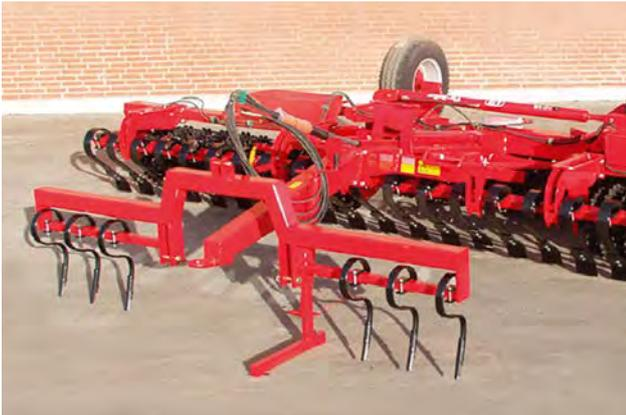
Borra huellas de ruedas de tractor opcional para su uso en laboreo delante de rodillos equipados con resortes.
