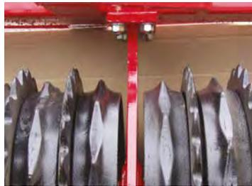
El eje de las secciones laterales de los Tip-Rollers de 8,2 m, 9,5 m y 10,2 m tiene un rodamiento de bolas en el centro como soporte adicional para evitar que el eje se doble.
