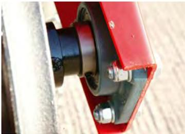
Los anillos están montados sobre ejes de 60 mm para una mayor resistencia y duración. Estos ejes están soportados con rodamientos de 4 tornillos protegidos dentro de acero de perfil en U.
