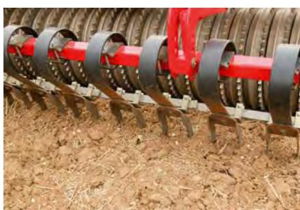
Ahora, la exitosa barra niveladora se ha mejorado aún más con la adición de "cuchillas" a la hoja accionada por resorte que aumentan el efecto de corte y rotura de terrones en terrenos más pesados. Estas cuchillas también pueden ajustarse en ángulo de ataque, hidráulicamente como la barra niveladora (izquierda).
