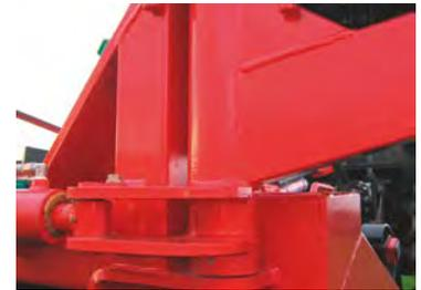
El mecanismo de plegado tiene un pivote de enlace de ala profunda con casquillo de acero recubierto de teflón superior e inferior para proporcionar rigidez para el trabajo, así como la rodadura.
